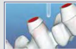
I ponti sono gestiti attraverso l'identificazione automatica dei sottosquadra con orientamento automatico dell'asse utensile.
