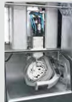
Dettaglio della camera di fresatura della Cam Impression 5-S2 con secondo asse ruotato.
